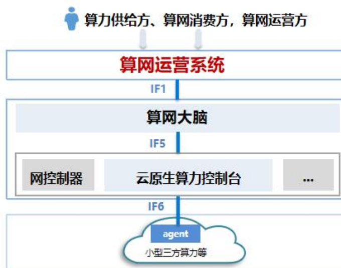
图5 算力并网-云原生算力纳管模式图
