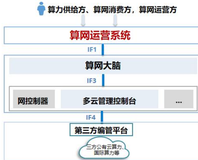
图 4 算力并网-编排管理层对接模式图
